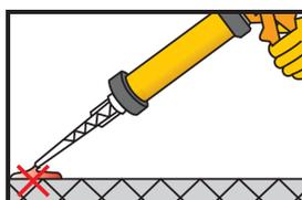
Par pressions sur la gâchette du pistolet, extruder le mélange en dehors du trou jusqu'à obtenir l'homogénéisation des 2 composants en sortie de buse (un mélange non homogène ne doit pas être utilisé pour effectuer un scellement). Relâcher la pression du pistolet, puis nettoyer le bout de la buse avant d'injecter la résine dans le trou de forage.
