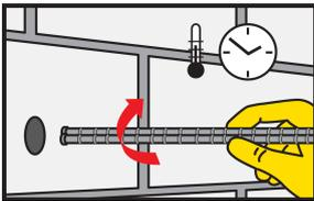
Engager immédiatement l'élément à sceller en lui imprimant un léger mouvement de rotation : veiller à introduire l'élément à sceller pendant le temps ouvert (voir § Vitesse de durcissement). La résine doit ressortir du trou de forage.
