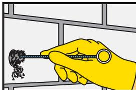
Effectuer le brossage à l'aide d'une brosse spéciale adaptée au diamètre du trou pour éliminer les particules de poussière (au moins 2 fois) ; le diamètre de la brosse doit être plus grand que le diamètre du trou.
