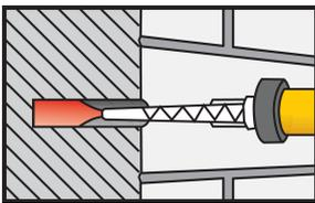
L'injection se fait en partant du fond tout en reculant progressivement la buse de mélange. Veiller à éviter les inclusions d'air dans le résine. Pour les trous profonds, un tube-rallonge peut être utilisé.
